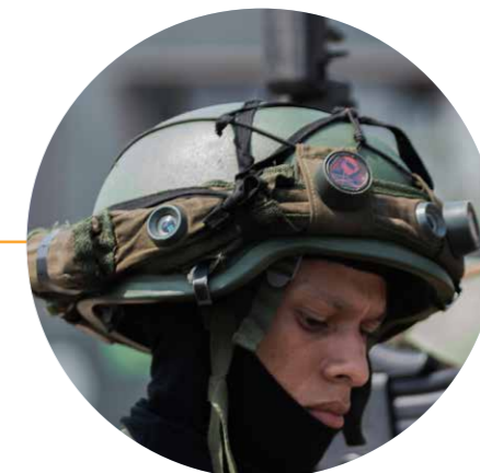
O sensor fornece a geolocalização da tropa e informa se um militar é atingido
