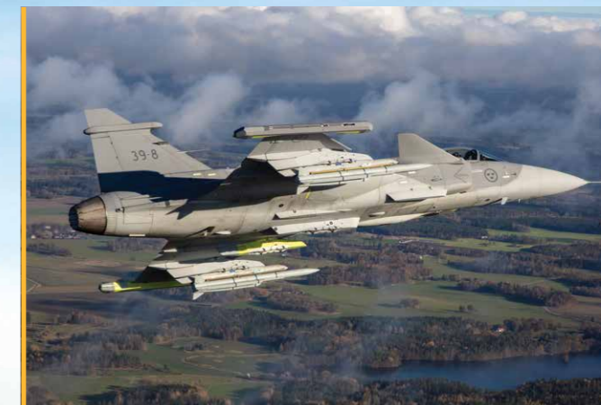
▼ Gripen E con misiles Meteor. El Gripen C/D operado por la Fuerza Aérea Sueca fue el primer caza del mundo que operó con misiles Meteor en 2016.
