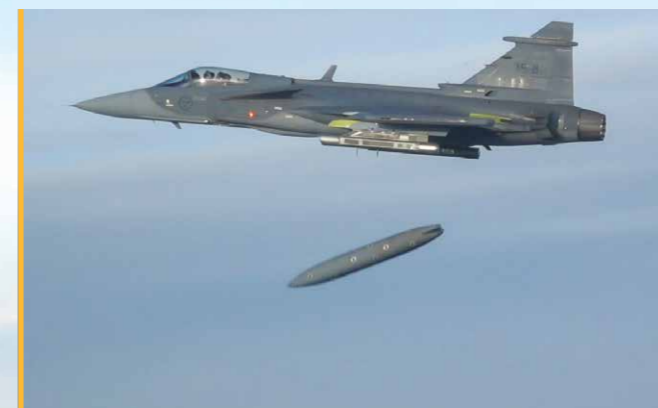
▼ Liberación de un tanque de combustible
