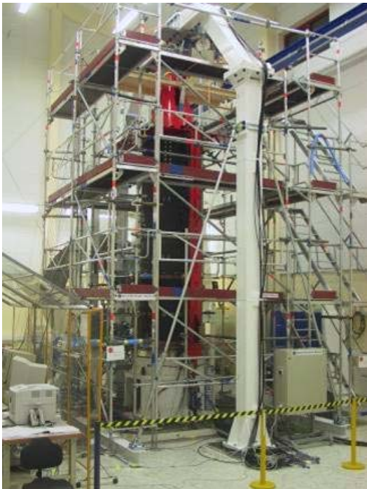
Centralröret i testjigg för statiska belastningsprover
