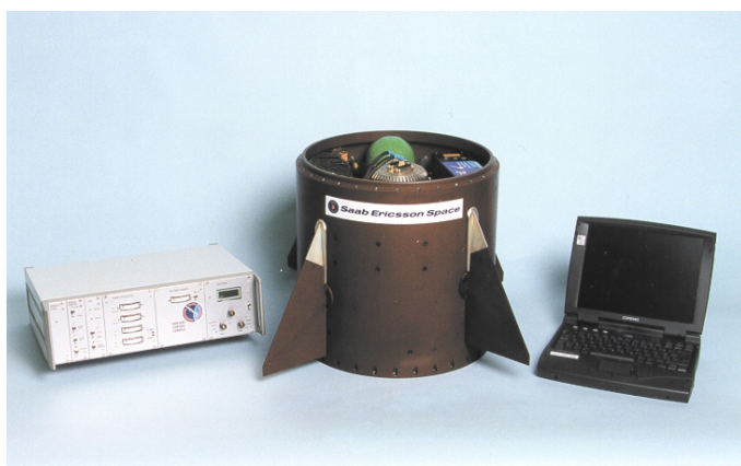
Ett styrsystem av typen S19D med sin markkontrollutrustning.
