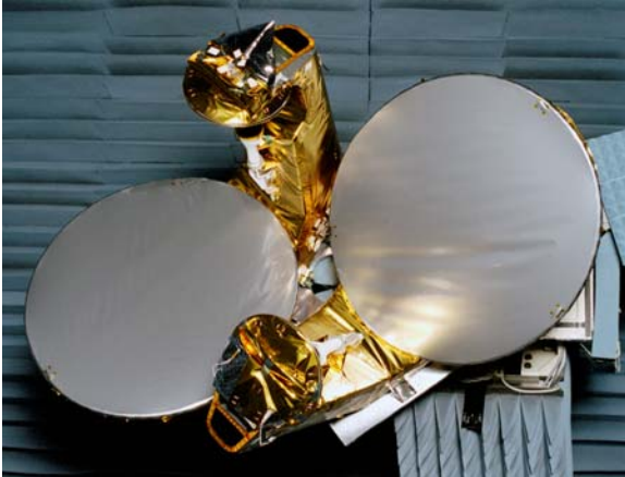
De Gregorianska reflektorantennerna klädda i termiska skyddsfilter.
