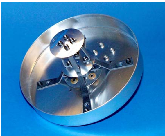
SMART-1 "Patch Excited Cup Antenna", liknande de som nu beställts till LCROSS.
