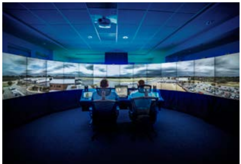
Saabs flygtrafikledningssystem Remote Tower är bland annat installerat på Leesburg Airbort i USA.
