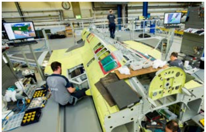
Här byggs det första provflygplanet i utvecklingen av Gripen E.
