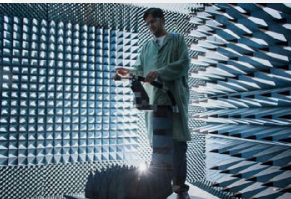
Förberedelser inför antennmätning vid Saabs radarverksamhet i Göteborg.
