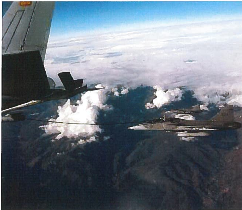
Gripen övar regelbundet med andra länders flygvapen. Lufttankning är ett sätt att öka flygplanets räckvidd vid internationella uppdrag.
