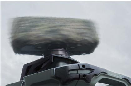
El Giraffe 1X está diseñado para realizar búsquedas en movimiento en cualquier configuración. Equipado con un avanzado sistema INS, el sensor se estabiliza automáticamente en tiempo real, permitiendo un funcionamiento completo mientras está en tránsito o durante el redespliegue. Mantiene el rastreo de objetivos y genera nuevos seguimientos con la misma eficacia que en una posición estacionaria, siempre con una orientación completamente estabilizada.
