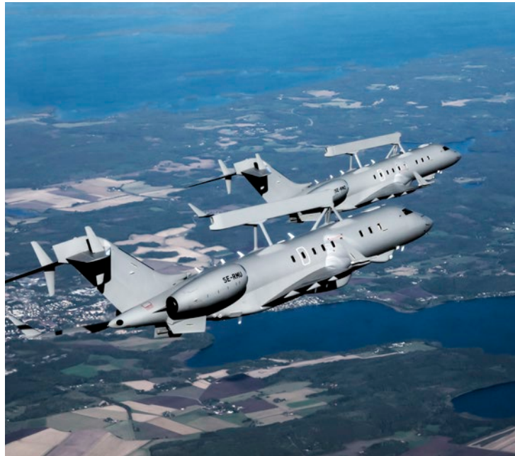
GlobalEye heeft een mix van moderne actieve en passieve sensoren, waarmee objecten in de lucht, op zee en boven land op grote afstand kunnen worden gedetecteerd.
