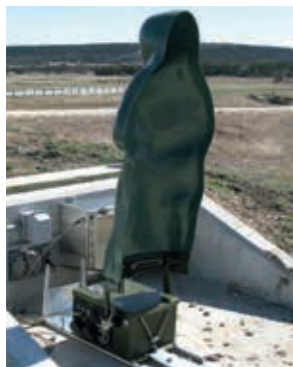
Alvo de Infantaria Estacionário (SIT – Stationary Infantry Target) Design robusto, com motor e conexões eletrônicas alojados em uma caixa estanque. Capaz de sustentar alvos de vários tamanhos, por meio de um suporte flexível.
