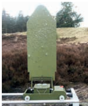
Alvo de Infantaria Móvel (MIT – Moving Infantry Target) Trata-se de um SIT montado em um carrinho autopropulsado. Velocidade ajustável entre 0 e 15 Km/h, representando um alvo caminhando, trotando ou correndo. Trilho desdobrável, de fácil reconfiguração.
