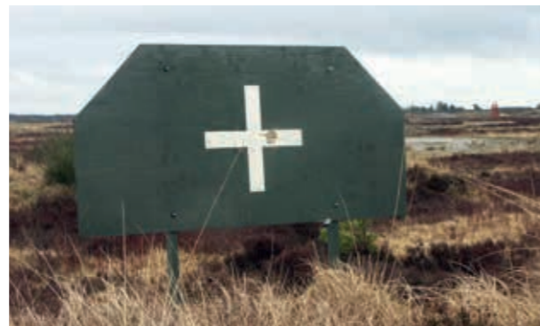
Alvo de Blindado Estacionário (SAT – Stationary Armour Target) Capaz de levantar até 136 kg (300 lbs). Corresponde a um alvo de 5 x 2,5 m e suporta vento até 15 m/s (35 mph).
