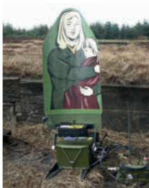
Alvo Giratório – Tiro de reação com discriminação amigo / inimigo. O suporte giratório inclui a capacidade de suportar alvos diversos.
