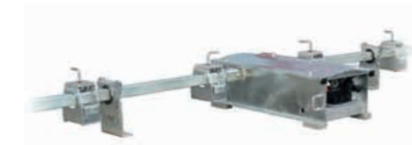
Alvo de Blindado Estacionário Pesado (HSAT – Heavy Stationary Armour Target) Capaz de levantar até 181 kg (400 lbs). Corresponde a um alvo de 7 x 2,5 m e suporta vento até 15 m/s (35 mph).
